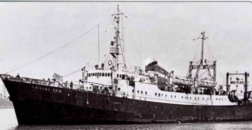
Fairtry LH 8, sem smíðaður var í Skipasmíðastöð John Lewis & Sons Ltd. Aberdeen, sjósettur 30. júní 1953. Skipið var 2605 gross tonn og 984 netto tonn. Lengd 74,7 m., breidd 13,4 m., knúð 2200 hð Doxford diesel-vél. Nýsköpunartogarinn Bjarnarey VE-11 var smíðaður í sömu stöð. Kom til Eyja í mars 1948. Varð síðar Norðlendingur ÓF-4, '55, og enn síðar Hrímbakur EA-5,'62.
